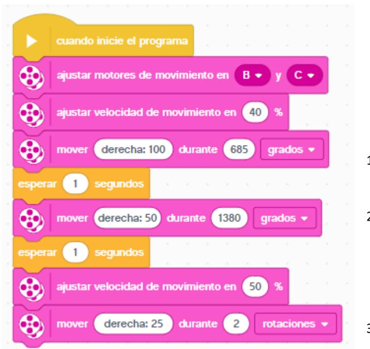
1.- En el bloque con el número 1, hacemos que la rueda izquierda va a una potencia de 40, mientras la rueda derecha va a una potencia de -40, durante 685 grados, realiza una rotación sobre sí mismo.
